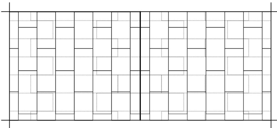
Disposizione sfalsata dei pannelli in cementolegno BetonWood® N rispetto ai pannelli accoppiati tipo Betonfiber sottostanti e giunto di dilatazione al centro (necessario in stanze e ambienti che superano i 40m<sup>2</sup>).
