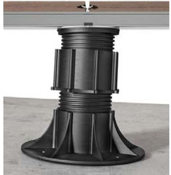
Supporti ad altezza regolabile da **28 a 550 mm** tipo **SE**. Testa basculante orientabile, adatta a massetti non planari.
