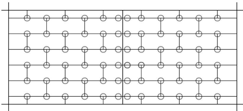
Collocazione di un giunto di dilatazione con posizione dei pannelli tipo **BetonWood® tongue&groove** in disposizione sfalsata.
